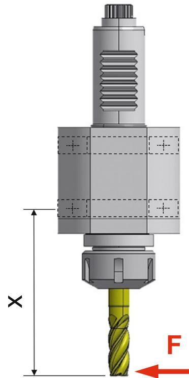
Die Höhe des Biegemoments  $M_b$  ist abhängig vom Messpunkt an der Achse (i. d. R. als  $x$ -Koordinate deklariert) und der Kraft  $F$ .
