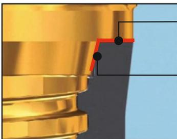
Axialanlage sorgt für Stabilität und Steifigkeit
